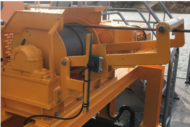
slack rope sensor
